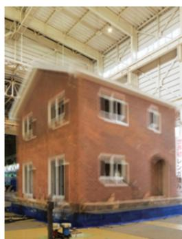
レンガの家は、地震に弱いのでは? とよくご質問をいただきます。茨城県つくば市の独立行政法人「土木研究所」にて、三次元耐震実験を行いました。阪神大震災の150%相当などの地震を連続4回行い、耐震性の高さを実証することに成功しました。木造+レンガ積みのW構造で、土台、柱、梁は自慢の骨太構造。地震にも安心です。
